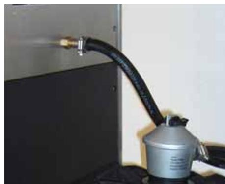
Montez le flexible du gaz sur le raccord rapide pré-assemblé ou sur le raccord fileté 1/4 de pouce (6,35 mm) (Fig. 6)
