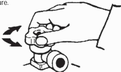
2. Contrôler que le raccord n'est pas endommagé avant de brancher. Fixer l'écrou de branchement (filetage à gauche) à la bouteille.
