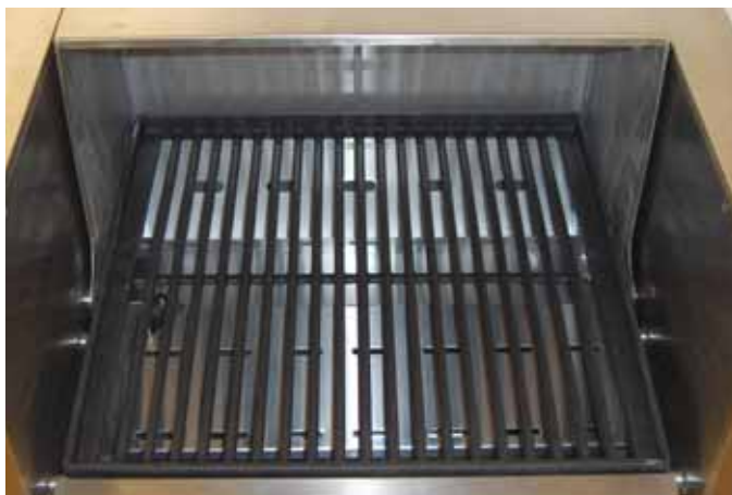
Instalar la bandeja de gotas y montar la protección contra llamas (Fig. 2+3)
